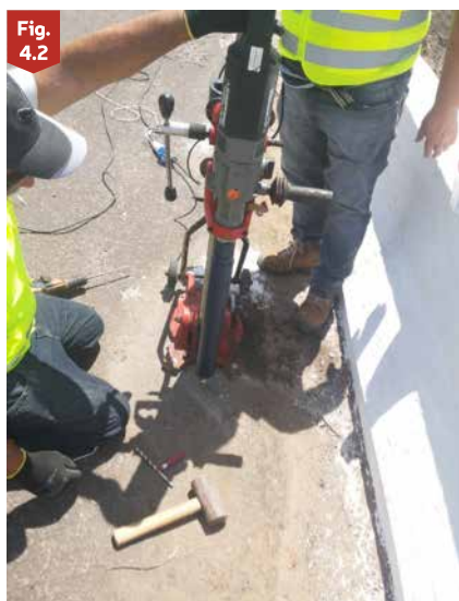
Ensaio de esclerometria em bloco de fundação, 4.1, e extração de testemunho de uma laje 4.2.
