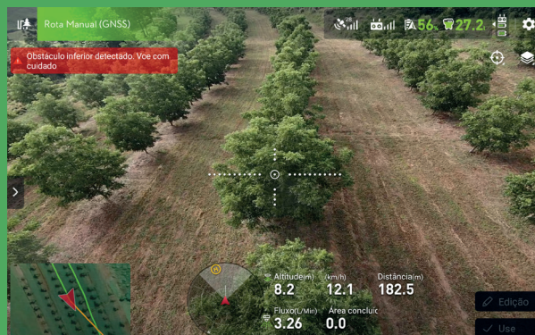
Figura 1. Drone pulverizador de asa rotativa ou multirotor, com destaque para o rádio controle. Visualização da tela do rádio controle que permite acompanhar a aplicação e o planejamento de voo durante o sobrevoo da área agrícola. Fonte: Daniel Pertussatti - Result Drones Agrícolas (2023).
