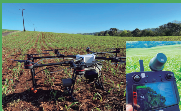
Figura 1. Drone pulverizador de asa rotativa ou multirotor, com destaque para o rádio controle. Visualização da tela do rádio controle que permite acompanhar a aplicação e o planejamento de voo durante o sobrevoo da área agrícola. Fonte: Daniel Pertussatti - Result Drones Agrícolas (2023).
