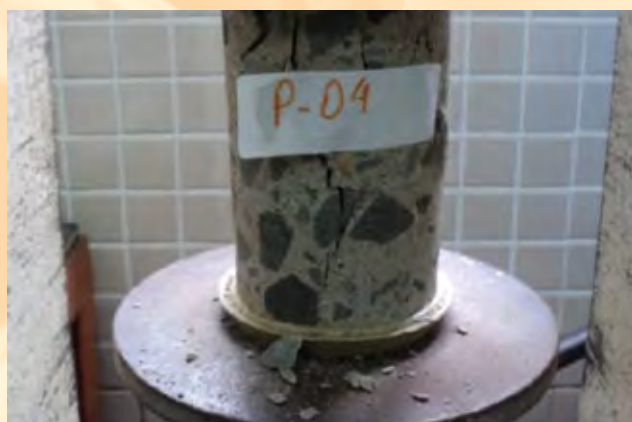
Figura 3 - Ensaio de resistência à compressão do testemunho de concreto
