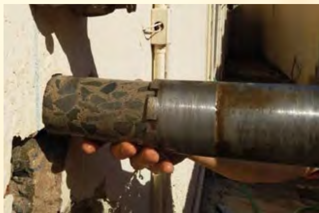
Figura 2 - Ensaio de extração de testemunho de concreto em elemento estrutural
