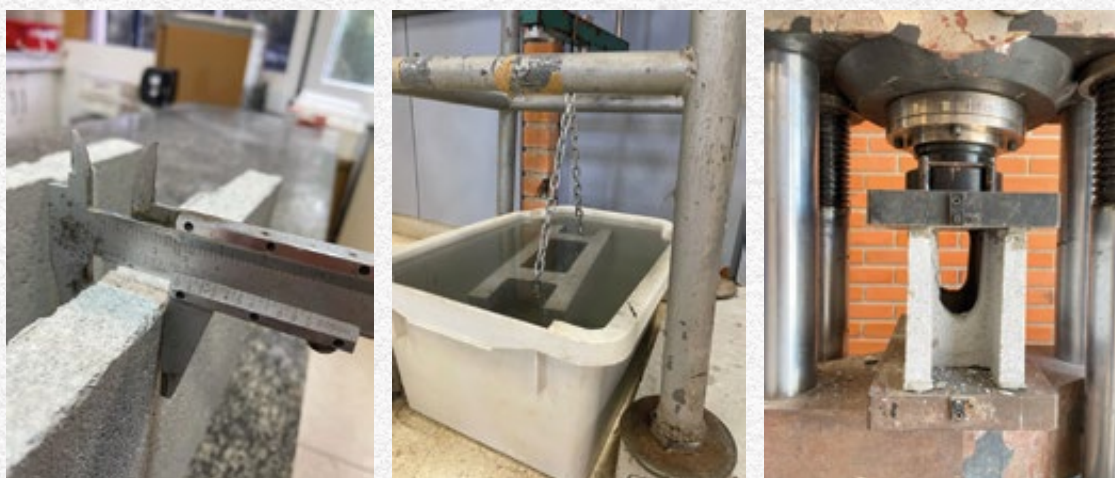
Figura 2 – Ensaio realizado no bloco (a) Medição com o paquímetro (b) Ensaio de absorção (c) Resistência à compressão do bloco.
