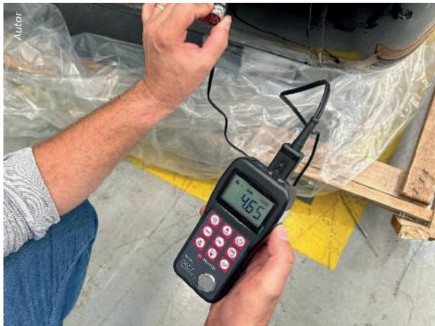
Figura 2 – Inspeção inicial em vaso de pressão novo para compressor
