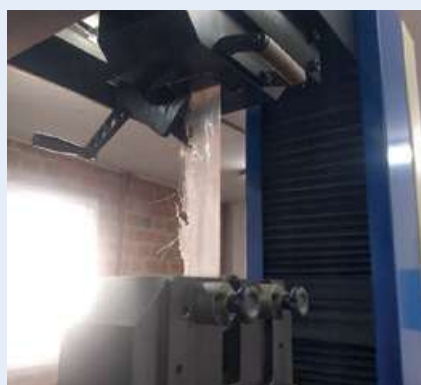
Figura 6 - Tira de PRFV tracionada na máquina universal para ensaio de tração
