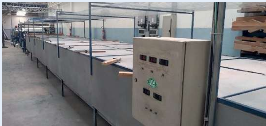
Figura 2 - Linha de produção da telha de PRFV
