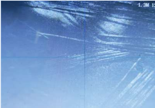
Figura 8 - Tira observada por microscópio com ênfase na disposição das fibras de vidro
