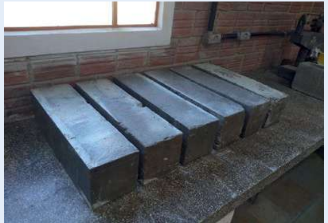
Figura 9 - Corpos de prova prismáticos de concreto
