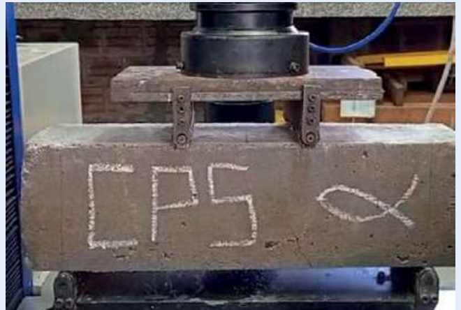
Figura 11 - Corpo de prova rompido, mas ainda unido em decorrência da não ruptura da fibra aderida ao concreto
