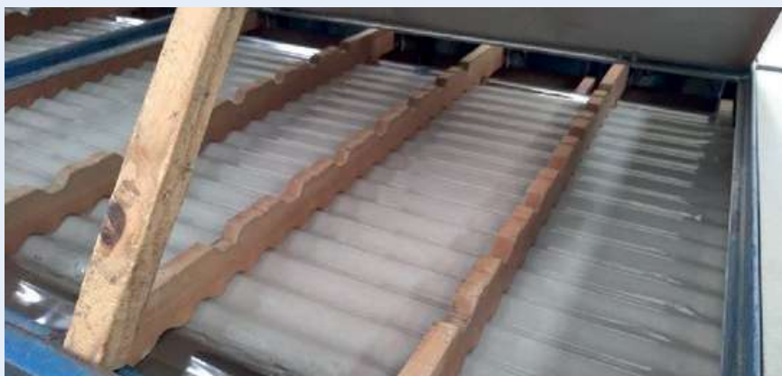
Figura 3 - Telha de PRFV em linha de produção
