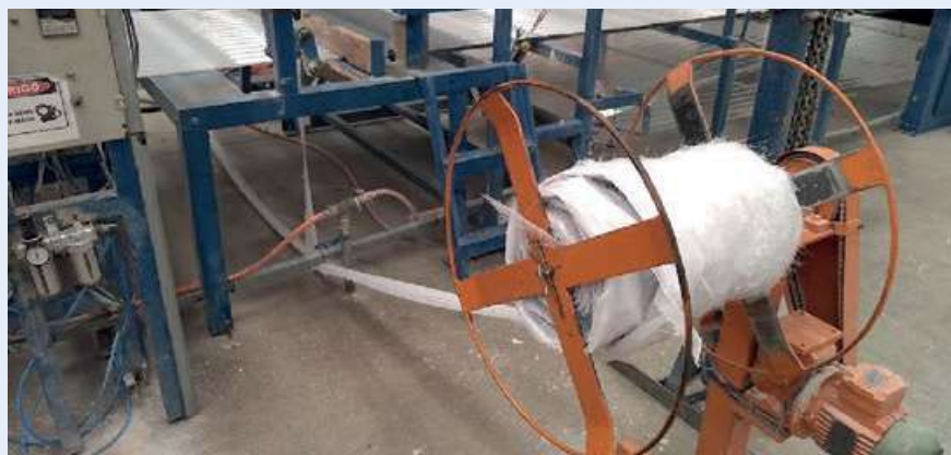
Figura 4 - Corte e coleta das rebarbas das telhas de fibra de vidro
