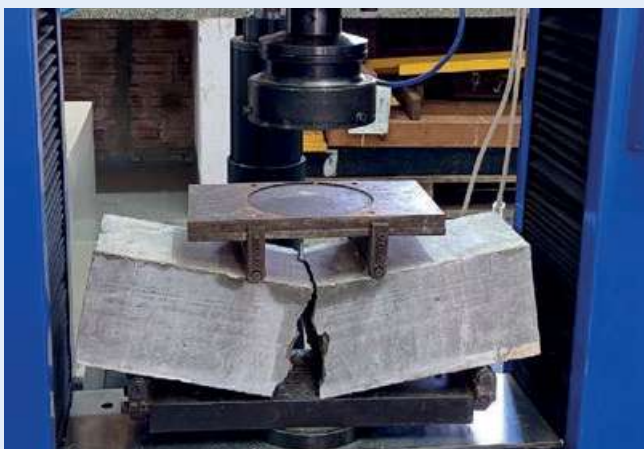
Figura 12 - Corpo de prova rompido sem a incorporação de tiras de PRFV
