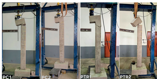
Figura 3 – Ruptura dos quatro protótipos, dois controles e dois treliçados. Fonte: Andrade (2025).
