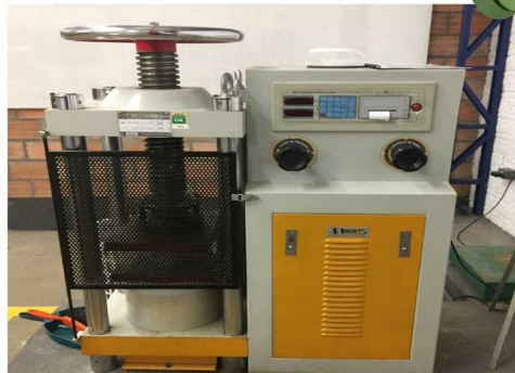
Figura 1 - Prensa para tensionar corpo prova. Fonte: o autor (2018).
