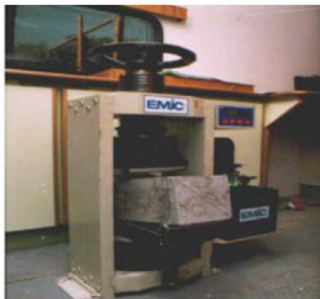
Ensaio de resistência à tração na flexão, em corpos de prova prismáticos, com carga aplicada nos terços médios, por meio de dois cutelos, segundo a norma ABNT NBR 12142:2010.
