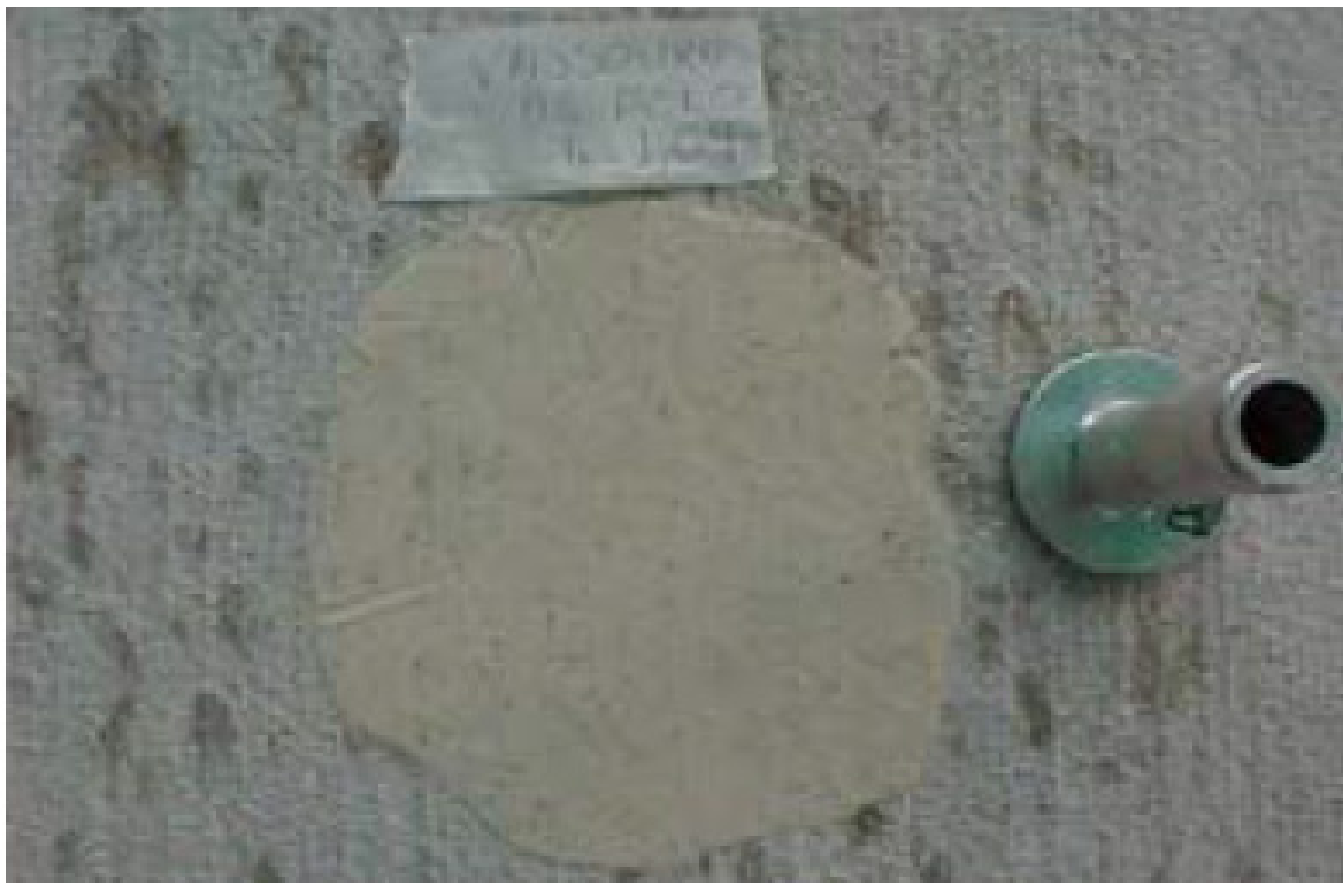
Ensaio de Mancha de Areia (ASTM E 965:2015).
