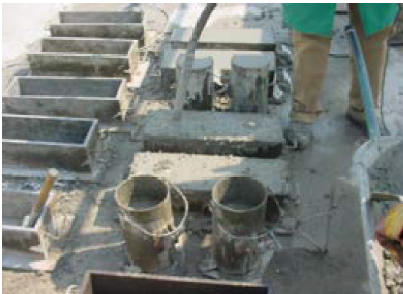
Moldagem de corpos de prova prismáticos, para determinação da resistência à tração na flexão do concreto.
